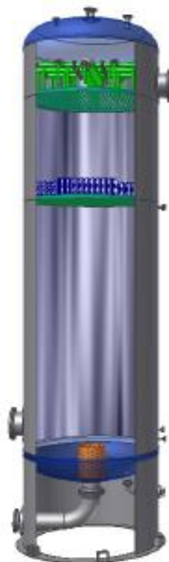
Figura 8. Esquema general del Sistema de remoción de CO 2 para PIA6
