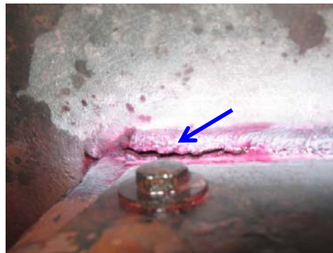
Figura 26 Grieta encontrada en el interior del domo, esquina sur de la unión entre el domo y accesorio interno. 40
