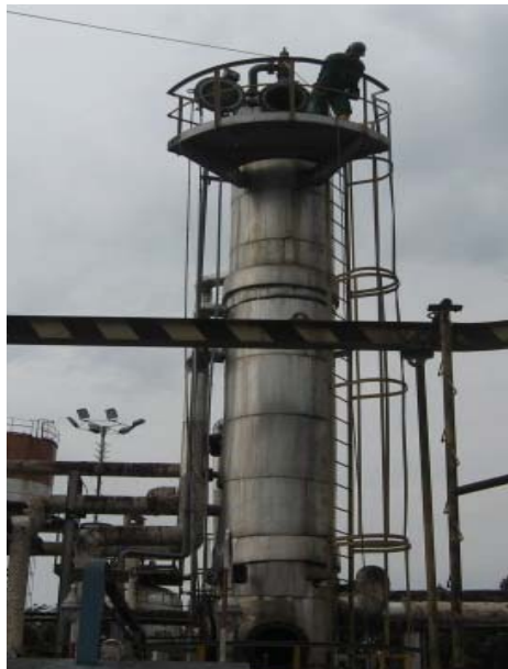
Figura 7 Torre de destilación Atmosférica 15
