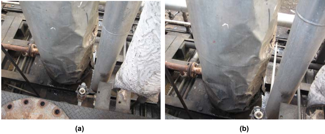
Figura 36. (a) y (b) Deformación y pérdida del recubrimiento de la parte inferior del foie. 50
