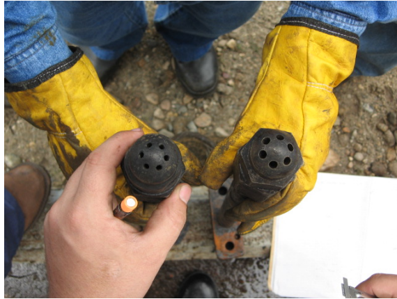
Figura 29. (a) y (b) Estado del refractario en las mirillas. 43
