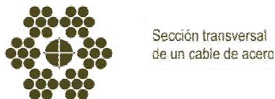
Figura 5. Disposición general de los cables de acero
