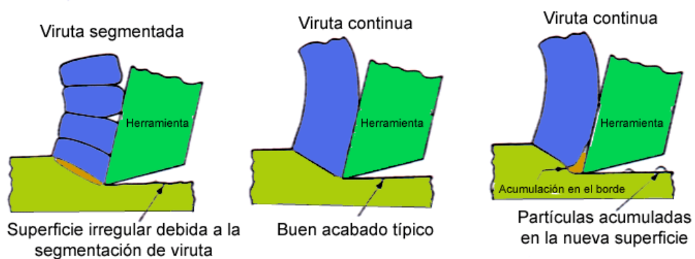
Figura 16. Tipos de formación de viruta en el corte de metales
