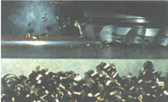
Figura 7. Operación de desbaste.
