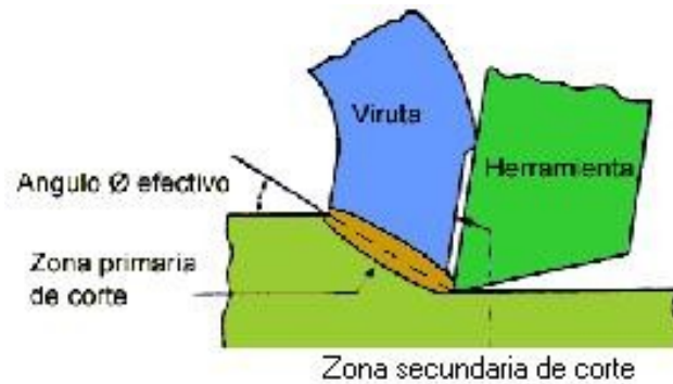
Figura 15. Visión realista de la formación de viruta.
