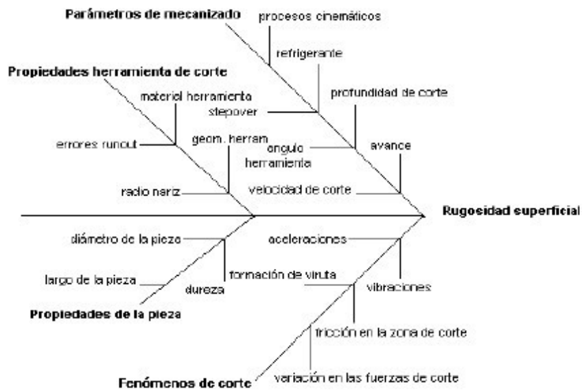
Figura 8. Factores de los que depende la rugosidad superficial.
