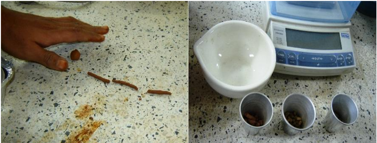
Figura 3-2 Procedimiento para realizar el ensayo de límite plástico Tomado por los autores
