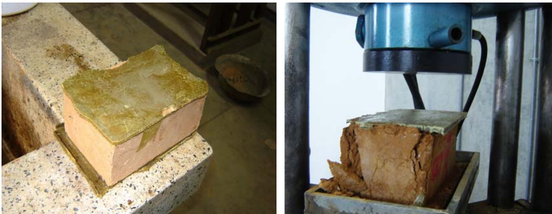
Figura 7-1 Bloques refrentados en azufre Tomado por los autores
