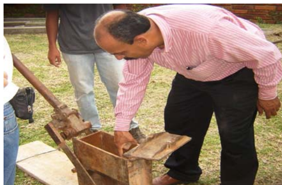
Figura 6-6 Llenado del molde Tomado por los autores
