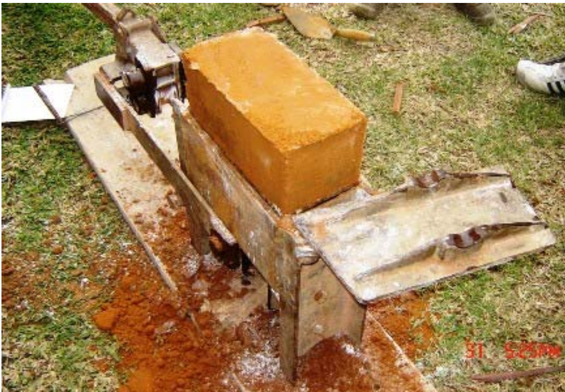
Figura 2-2 Prensa CINVA RAM utilizada en la investigación Tomado por los autores
