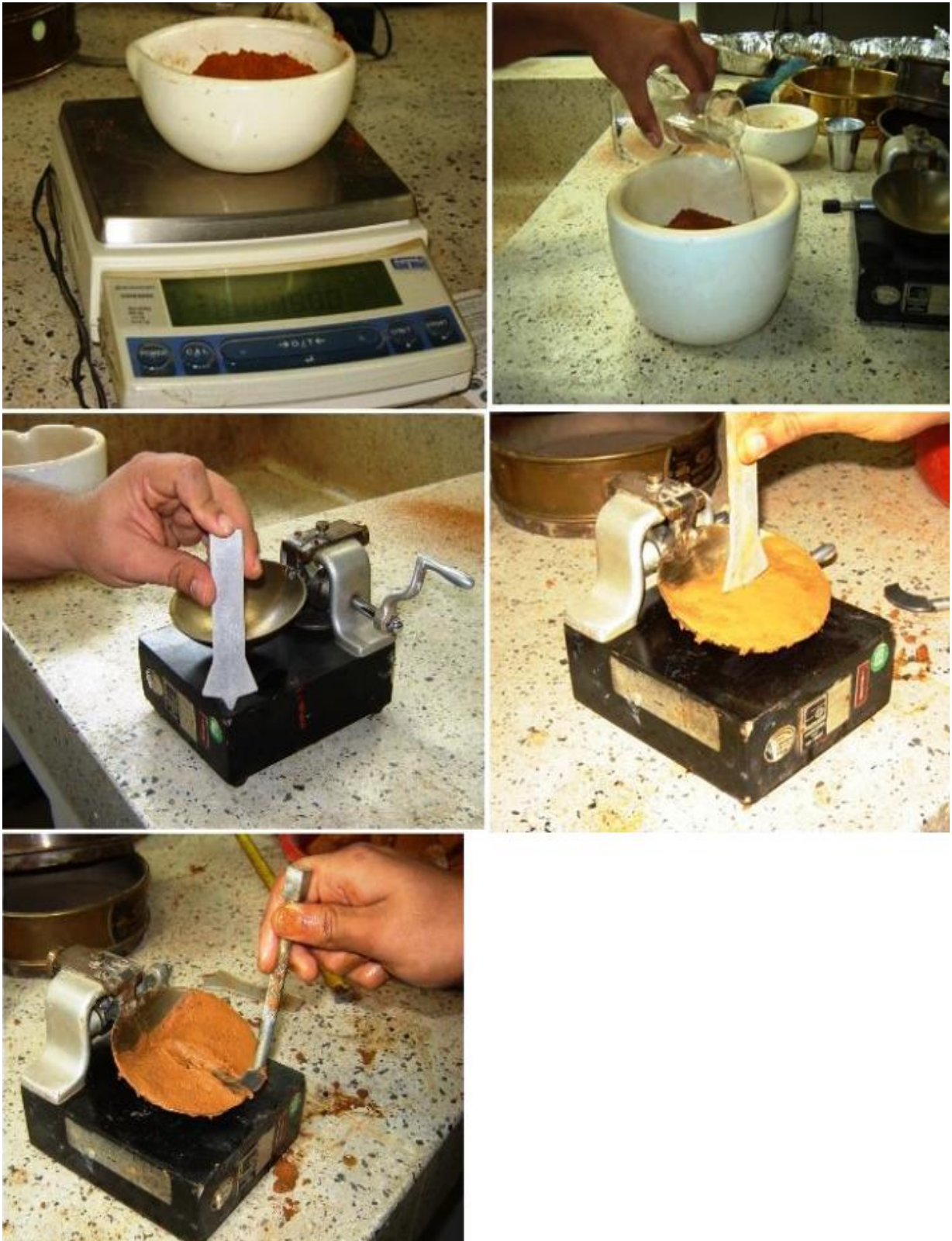
Figura 3-1 Procedimiento para realizar el ensayo de límite líquido Tomado por los autores
