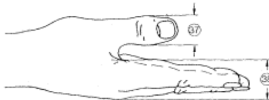
Figura: Tabla con las principales medidas de la mano (Según Norma DIN 33.402 segunda parte.
