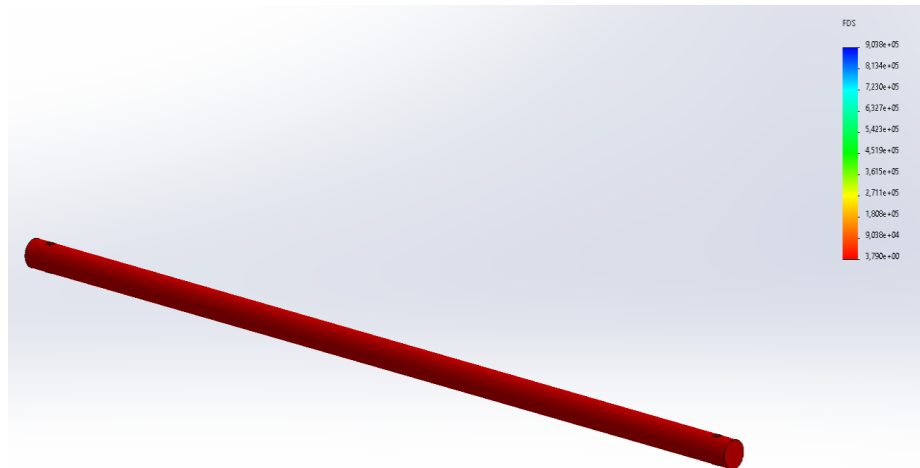
figura E-7 Análisis de factor de seguridad
