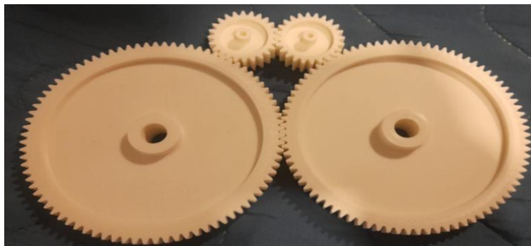
Figura 22 Impresión de 3d de los engranajes
