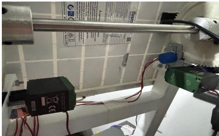
Figura 32 Conexión del Arduino con motores y potenciómetro
