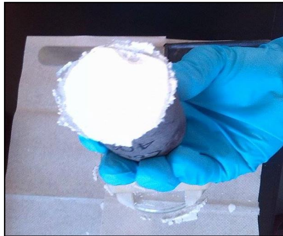
Figura 15. Muestra para montaje equipo presión capilar.
