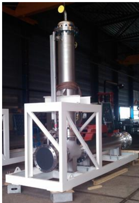
Figura 13: Equipo de separación Avanzada Inline Degasser.
