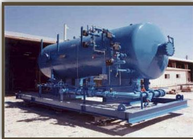
Figura 3: Tratador térmico compañía EN-FAB
