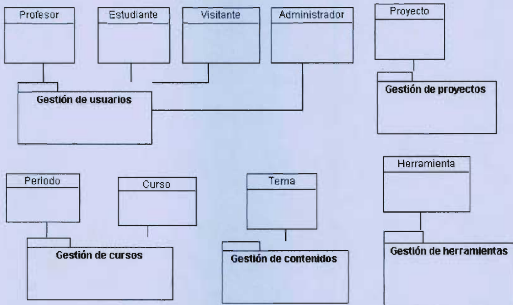
Figura 13. Identificación de paquetes de análisis a partir de las clases de dominio.
