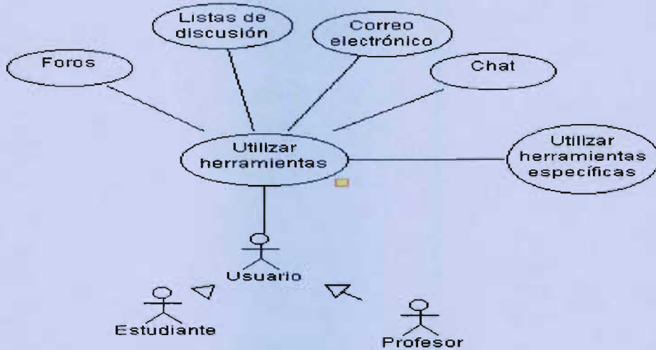
Figura 27. Modelo del caso de uso utilizar herramienta
