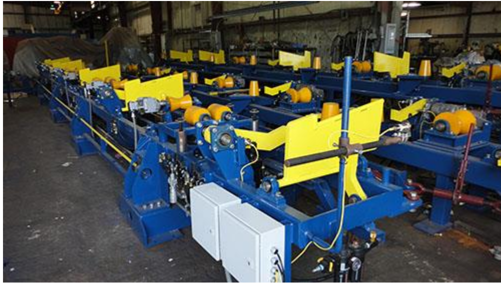
Figura 21. Equipo de manipulación y carga de tubería
