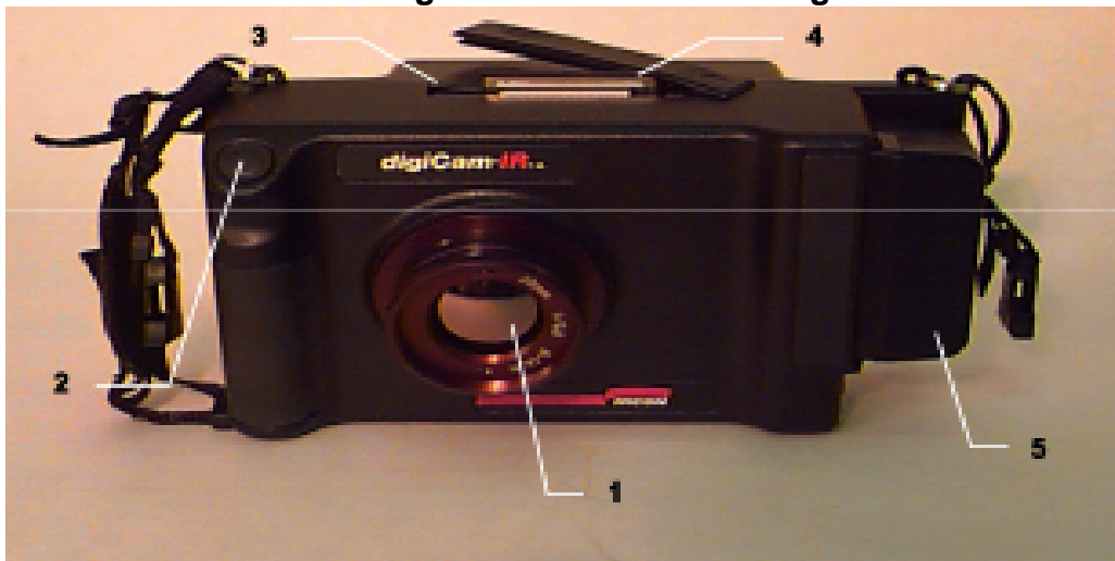
Figura # 14 Cámara termografía
