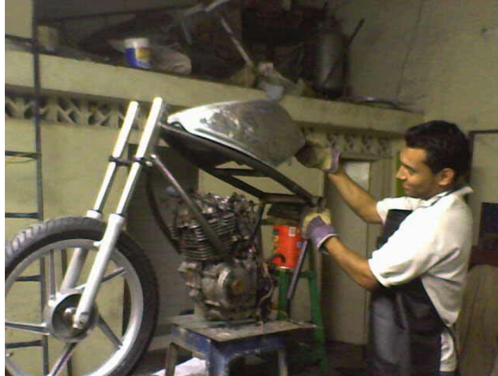
Figura 94. Ubicación del tanque en el chasis.
