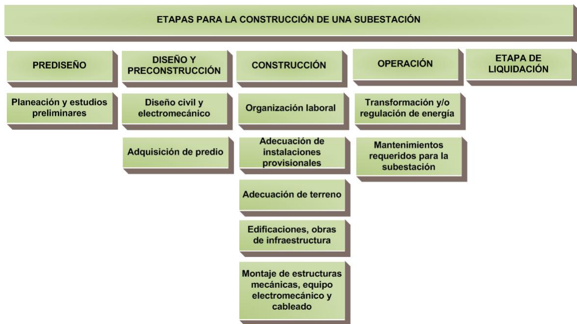
Figura 2.10: Etapas de construcción de una subestación
