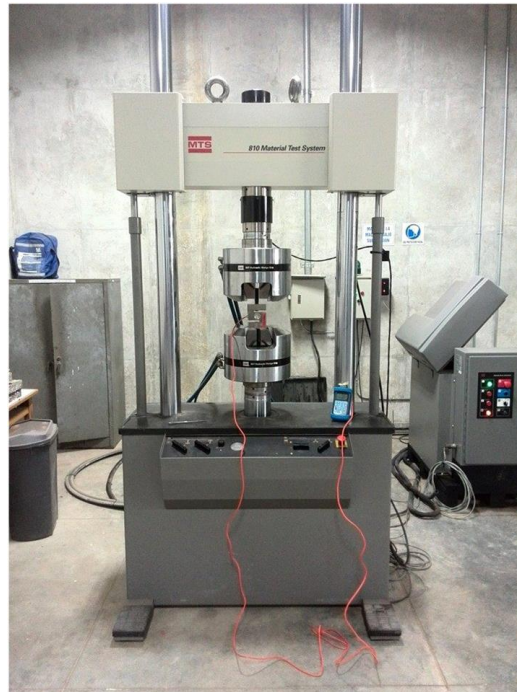
Figura 23. Montaje celda tipo S con el LOADCELL II en la MTS 810
