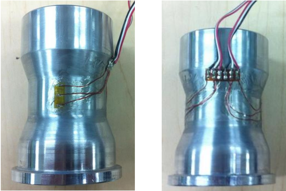
Figura 27. Pegado de la galga y cableado
