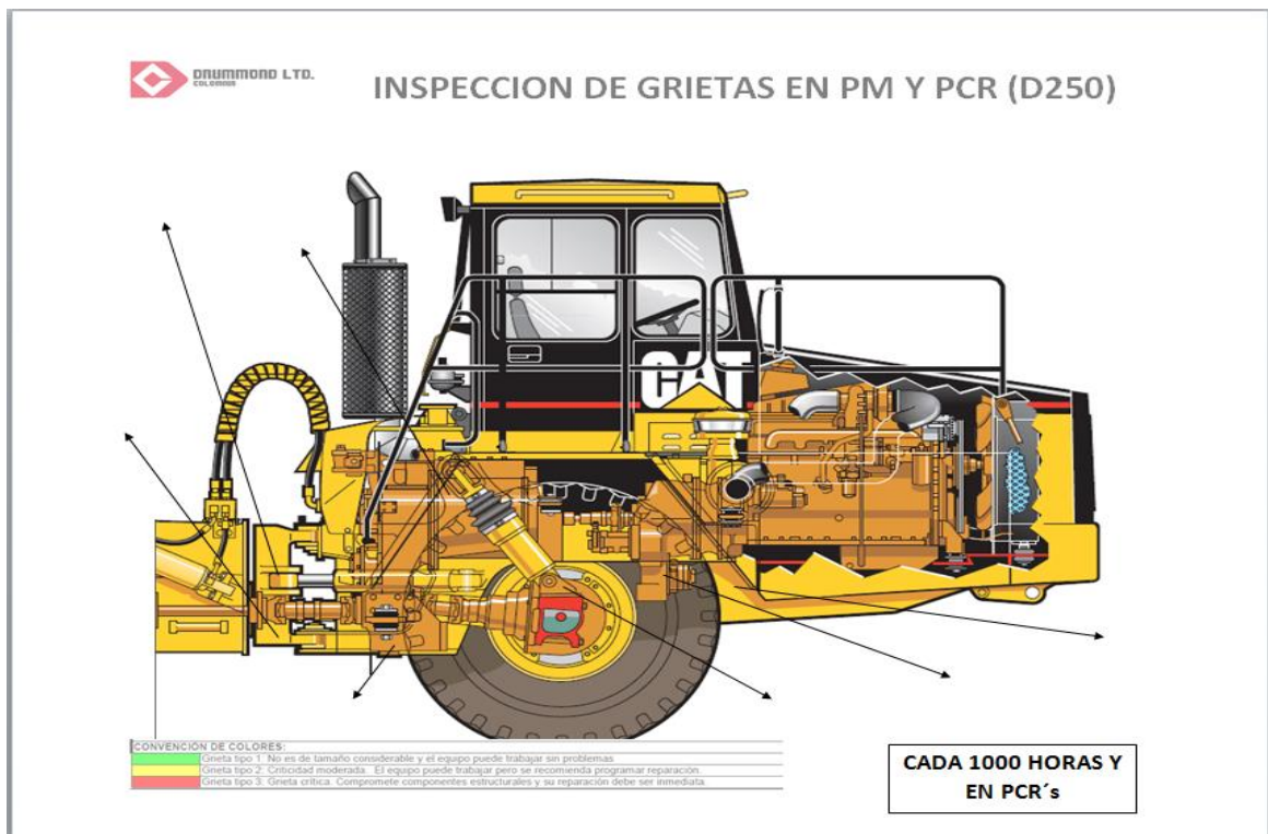
Figura 56. Formato1 de inspección de grietas en PCR's
