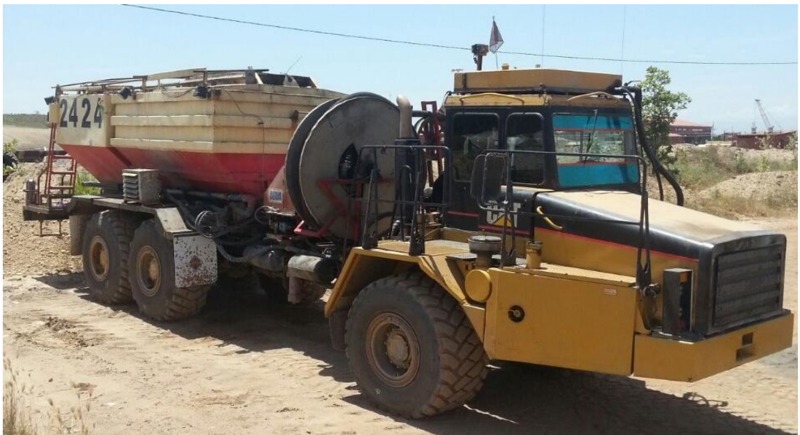
Figura 8. Camión Articulado D250 con sistema ANFO.
