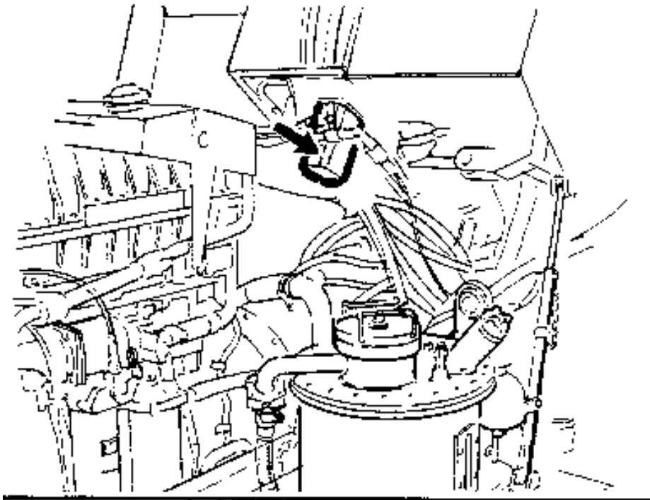
Figura 25. Ubicación válvula freno de servicio
