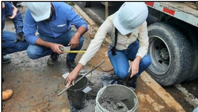
**Figura 12** Toma de temperatura para verificación de nivel de fraguado del concreto Obra Guillermo Díaz. Fuente: Autor.
