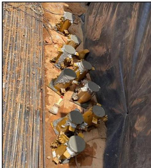
Las muestras se cargaban en la plataforma del laboratorio que realizaría el ensayo de resistencia de la siguiente forma: 2 muestras a 7 días, 2 muestras a 14 días, 2 muestras a 28 días y 3 muestras de testigo en caso de que si no se cumplía la resistencia esperada a los 28 días estas últimas se enviarían de respaldo (resistencia a 56 días) y como último recurso antes de recurrir a la extracción de núcleos para la verificación del cumplimiento de resistencia del elemento.
