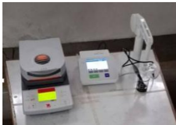
Fotografía 3. Instrumentos utilizados para la toma y registro de datos de pH y humedad.
