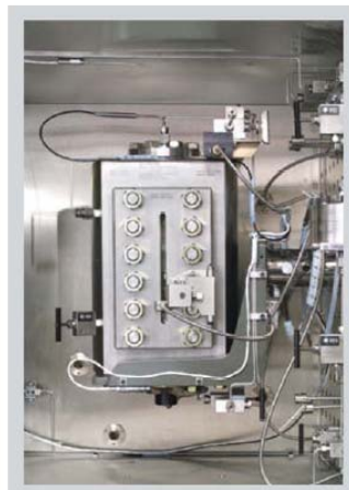
Foto 6: Celda de Comportamiento de Fases PV Fuente: Laboratorio de análisis PVT-ICP
