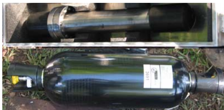
Foto3: Cilindros de transporte de Aceite (superior) y de Gas (inferior) Fuente: LAB: de Análisis PVT-ICP
