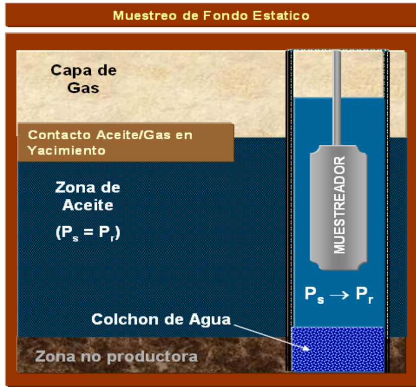
Figura 13: Acondicionamiento adecuado para muestreo de fondo Estático Fuente: PVT Studies Well Conditioning & Sampling (Six Steps to Quality PVT Data) Pencor
