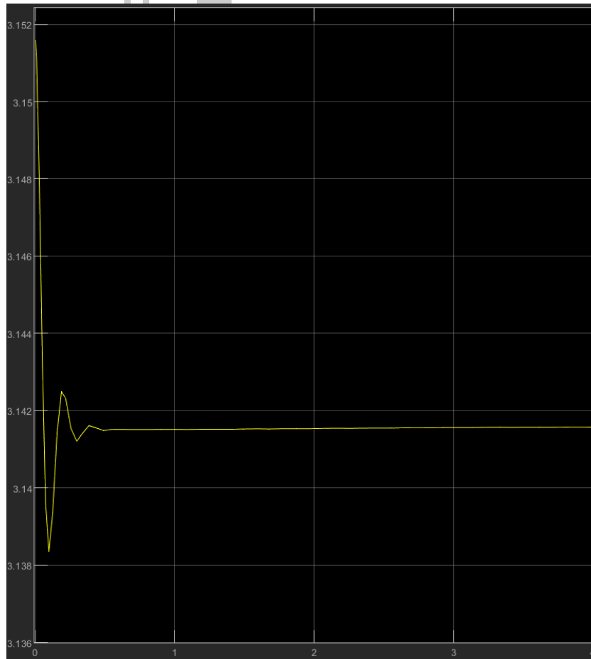
FIGURA 24. GRAFICA DE ESTABILIZACION DE LA PLANTA VIRTUAL CON CONTROL PID
