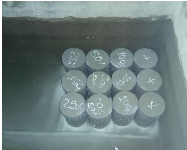
Ilustración 6. Desencofrado de los especímenes de concreto y curado en tanque
