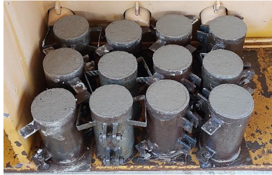
Ilustración 5. Proceso de fraguado de los especímenes de concreto
