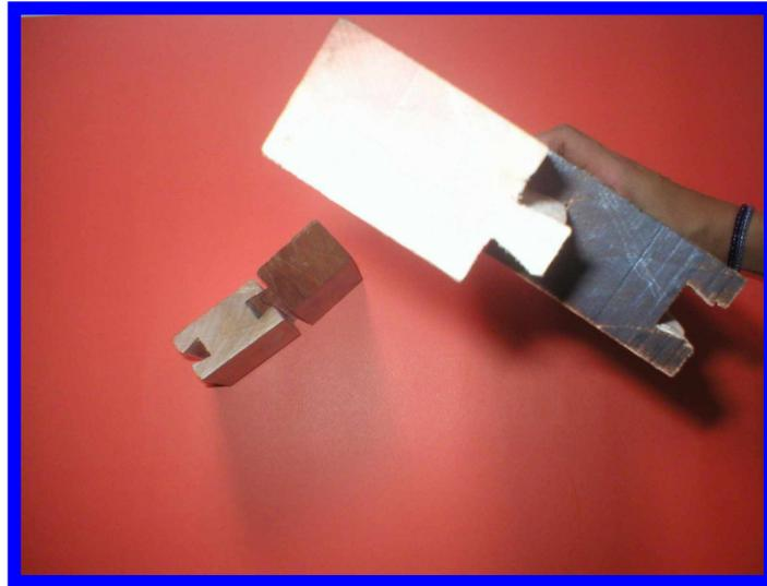
Figura 161. Funcionamiento del ensamble.
