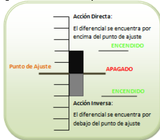
Figura 2: Control de dos posiciones ON-OFF
