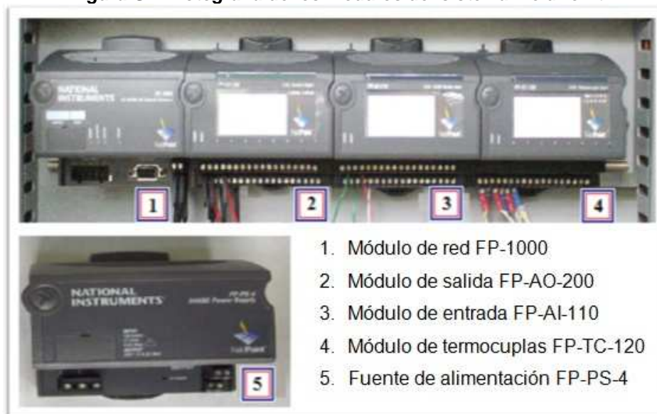
Figura G.1. Fotografía de los módulos del sistema FieldPoint
