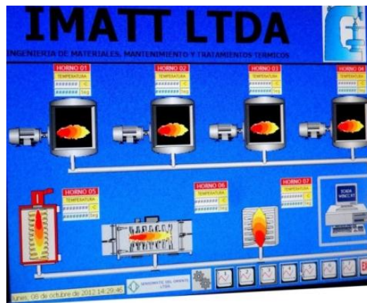
Figura 7. Visualización Pantalla de mando Software Simatic Win CC Flexible.
