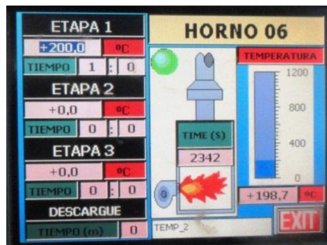
Figura 10. Visualización Pantalla Gráfica del proceso de tratamiento térmico Software Simatic Win CC Flexible.
