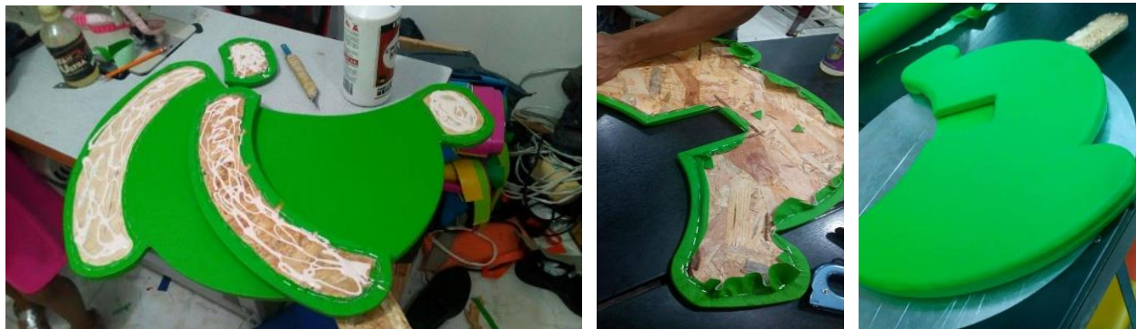
Figura 37. Fotografía fabricación de forros para las piezas.
