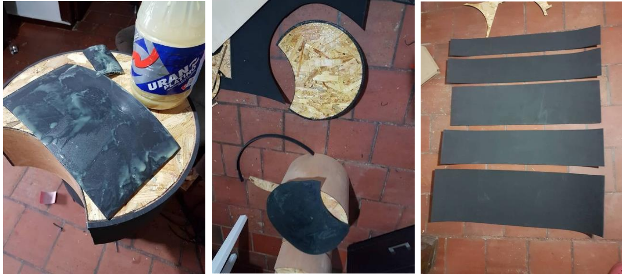
Figura 36. Fotografía adhesión de recubrimiento en piezas de madera.
