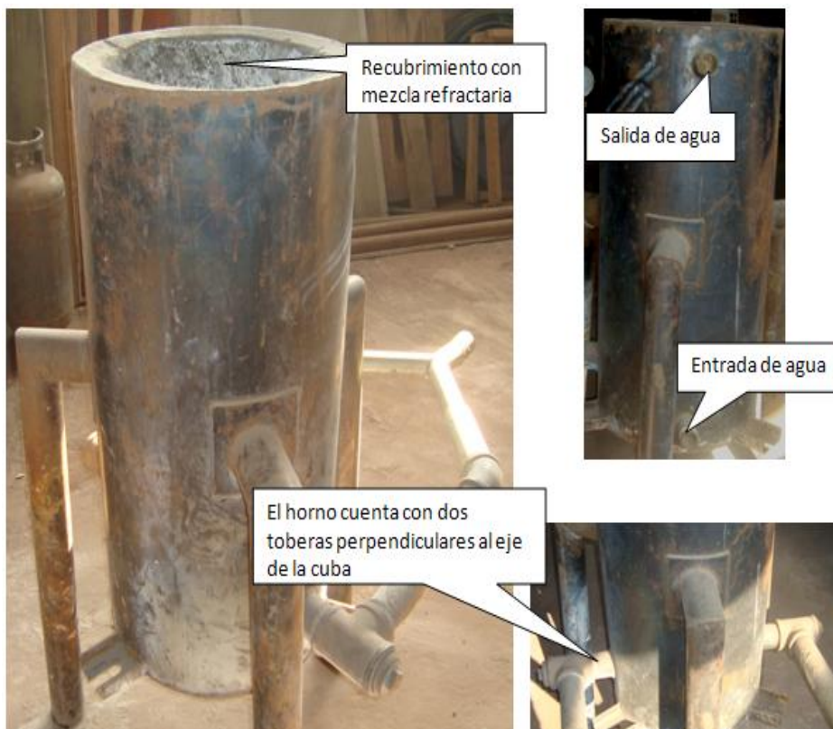
Figura 5 Fotografía de las partes de la carcasa del horno
