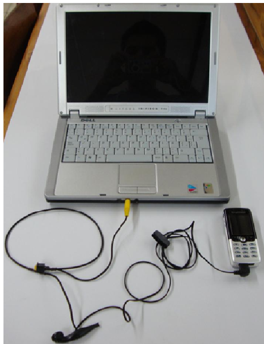
Figura 34. Conexión del cable manos libres al celular y al equipo de cómputo Fuente: Autores del Proyecto
