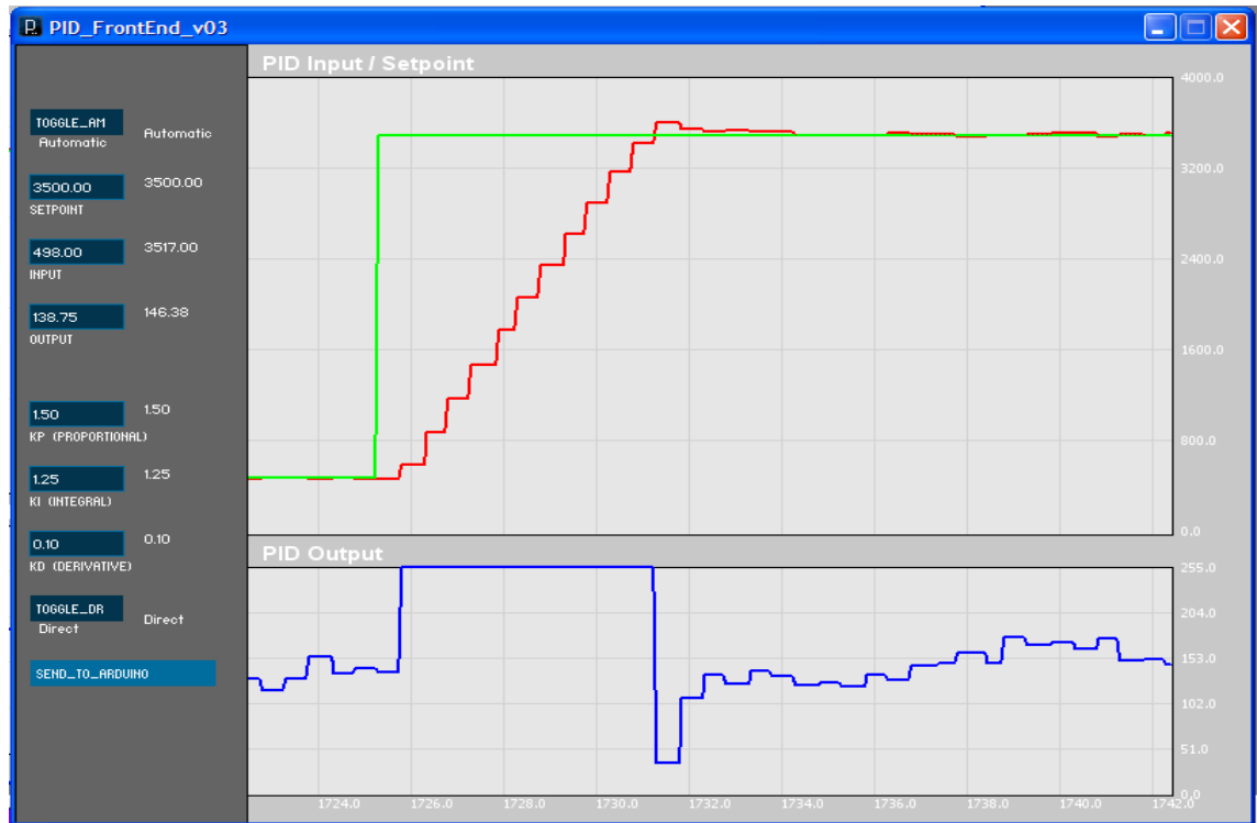
Figura 56. Escalón a 35 [cm] con la válvula proporcional.
