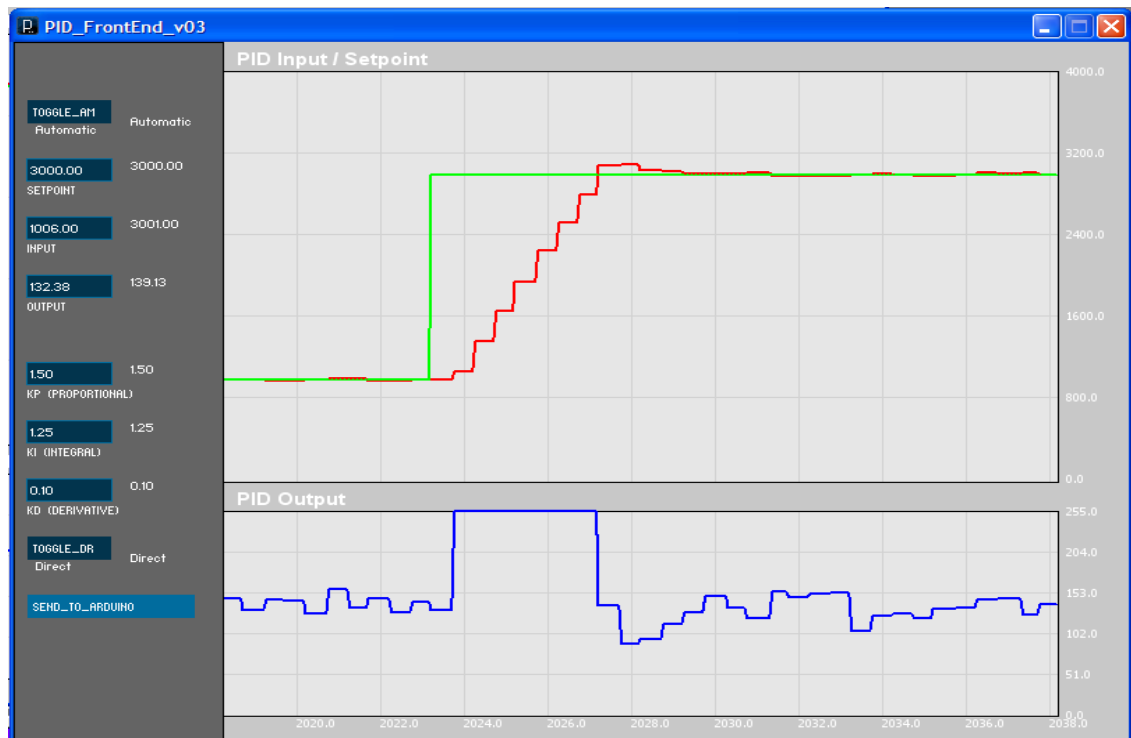
Figura 55. Escalón a 30 [cm] con la válvula proporcional.
