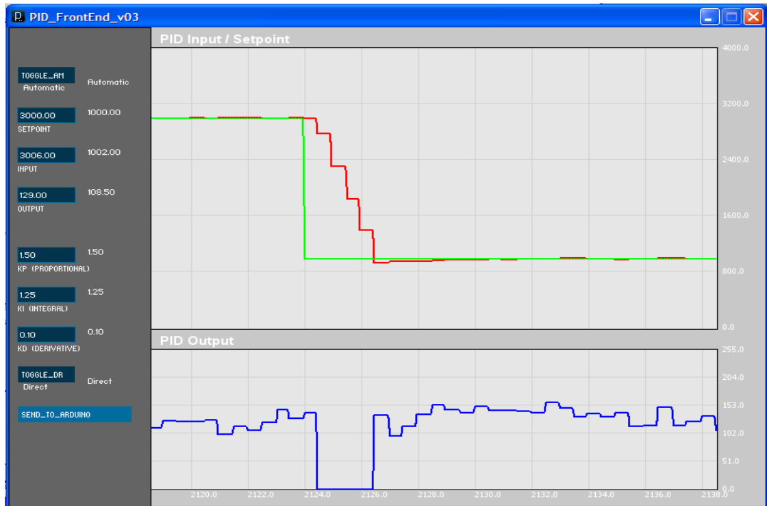
Figura 52. Escalón a 10 [cm] con la válvula proporcional.
