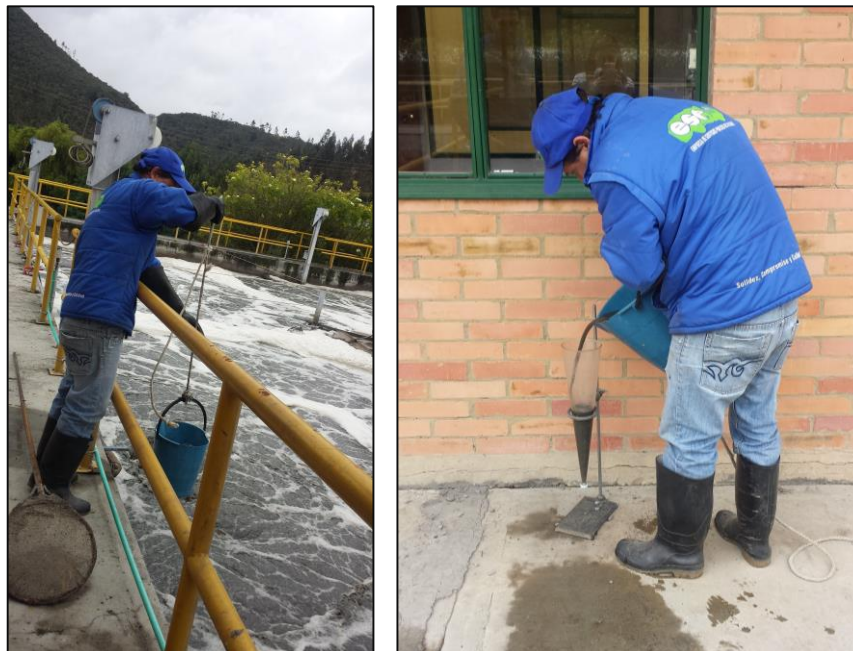
Fotografía 7. Toma de muestra para medición de los sólidos sedimentables.
