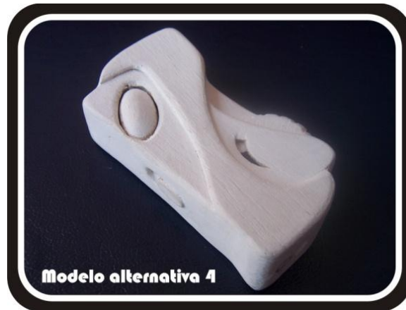
Figura 11. Fotografía del modelo construido correspondiente a la cuarta alternativa de carcasa
