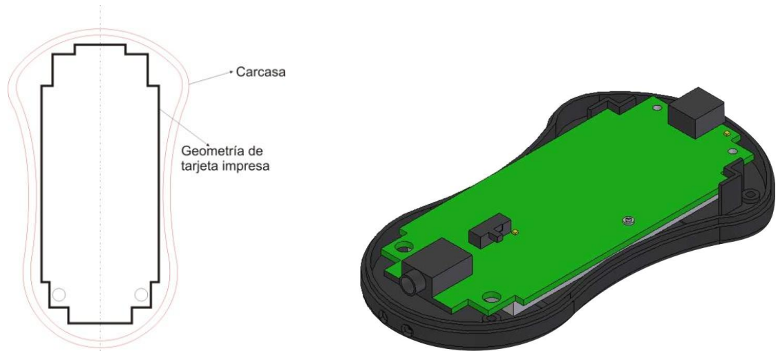
Figura 28. Circuito impreso a partir de la forma de la carcasa
