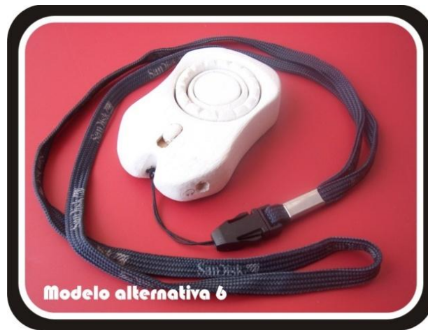
Figura 15. Fotografía del modelo construido correspondiente a la sexta alternativa de carcasa
