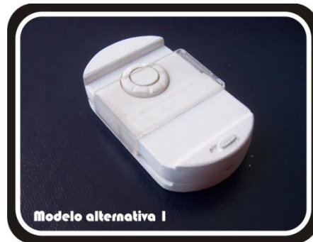
Figura 5. Fotografía del modelo construido correspondiente a la primera alternativa de carcasa
