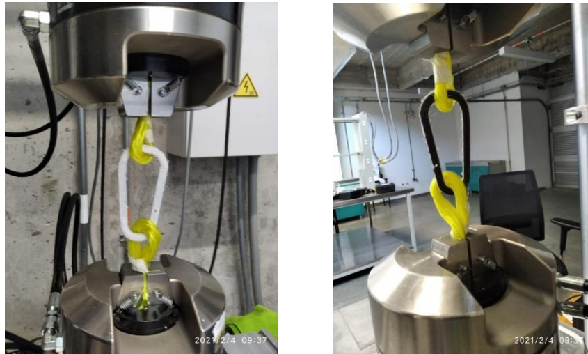
Figura 89. Ensayo de tracción para mosquetón tipo HMS fabricado con nylon y refuerzo con fibra de carbono.
