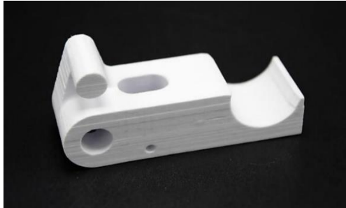
Figura 20. Pieza realizada en impresora 3D de laminación de hojas.
