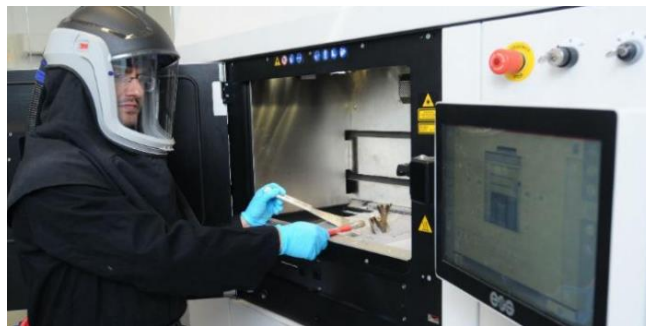
Figura 19. Impresora 3D de fusión por lecho de polvo.
