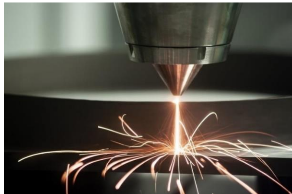
Figura 16. Máquina de impresión por deposición de energía directa.
