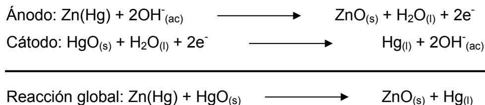
Figura 5. Reacciones que ocurren en la celda de una batería de mercurio [47].
