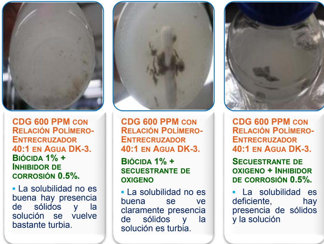
Figura 46. Evaluación CDG con el Inhibidor de Corrosión y Biócida (0.5%) y Biócida a (1%).
