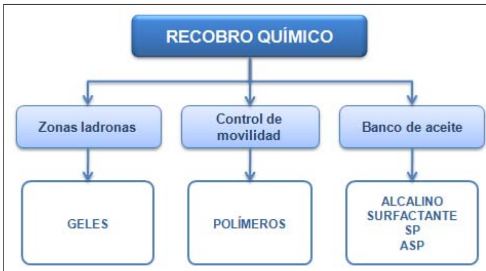
Figura 1. Clasificación de los métodos de inyección de químicos.
