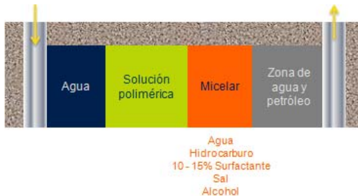
Figura 6. Esquema de Procesos de Inyección de Micelares.
