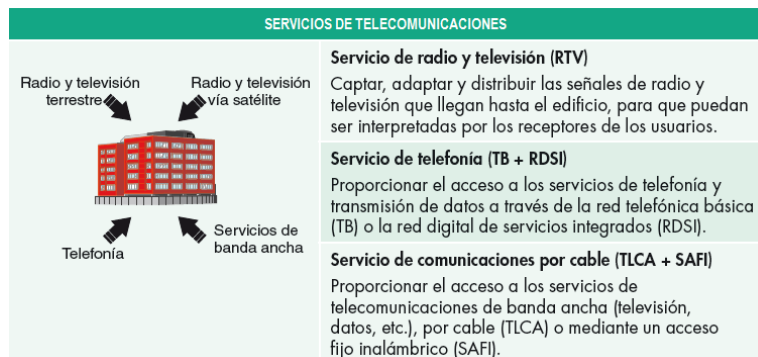
Figura 47. Servicios de telecomunicaciones
