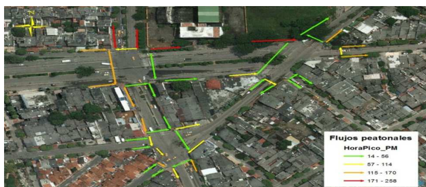
Figura 10. Distribución espacial de los viajes realizados a pie para las 17:45 y las 18:45.
