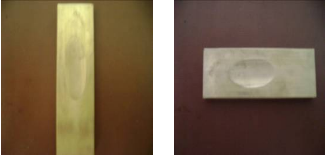
Fig. 30 Fotografía huella de desgaste en latón 63 – 37
