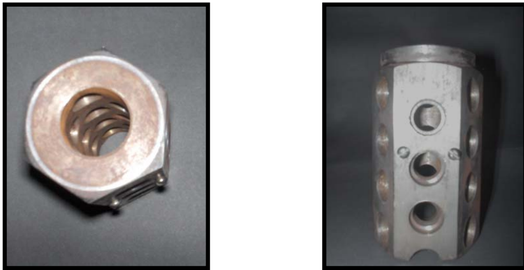
Figura 2.3. Portamuestras en acero SAE 4140. Vista superior (izquierda), vista lateral (derecha)
