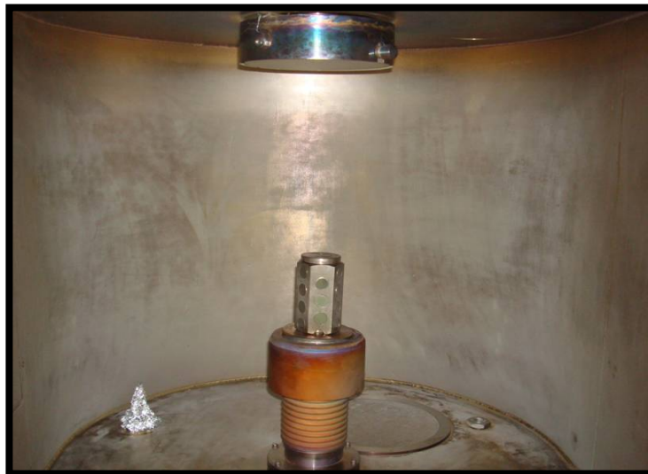
Figura 2.5. Montaje de las probetas en la cámara de vacío del dispositivo JUPITER antes del proceso de implantación
