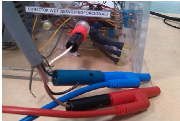
Figura 30. Detalle conexión señal del sensor
