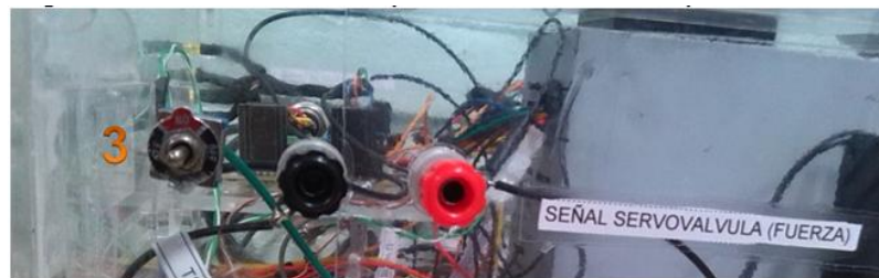
Figura 24. Detalle interruptor 3, control de la perturbación
