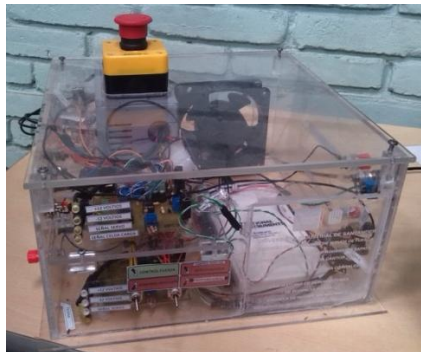
Figura 22. Módulo de adecuación de señales
