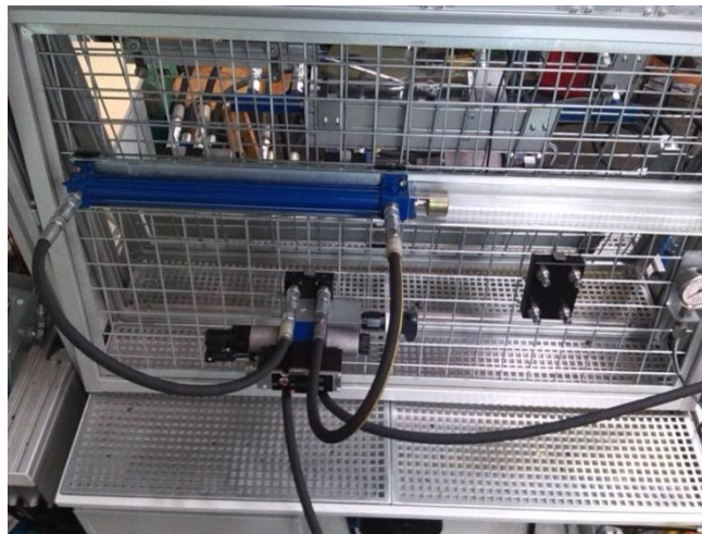
Figura 33. Montaje hidráulico del servo de velocidad.
