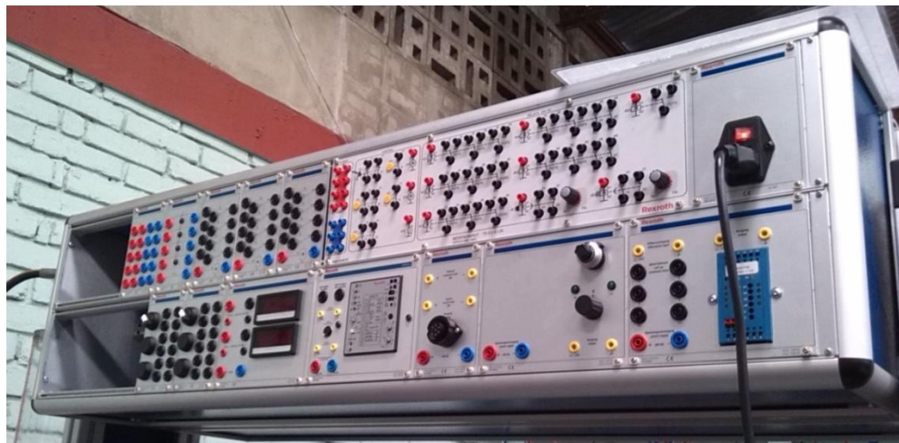
Figura 6. Módulo para montajes eléctricos del banco
