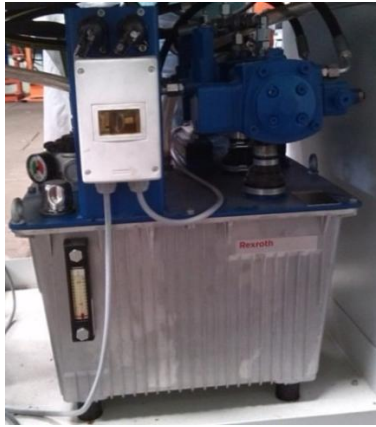
Figura 4. Módulo de potencia del banco
