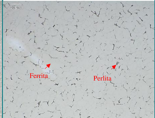
Figura 12. Microestructura a 500x acero A36 hot-rolled. Sección transversal.
