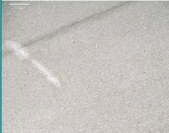
Figura 11. Microestructura a 100x acero A36 hot-rolled. Sección transversal.
