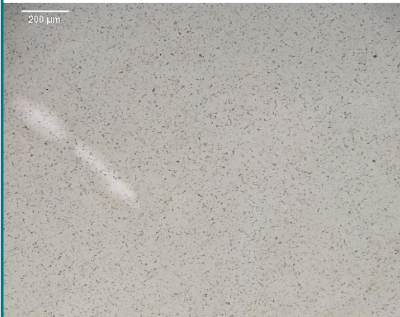
Figura 11. Microestructura a 100x acero A36 hot-rolled. Sección transversal.
