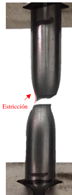
Figura 6. Probeta cilíndrica de acero AISI SAE 1045 Cold-Rolled fracturada luego del ensayo de tracción.
