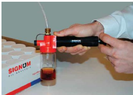
Figura 14. Extraer muestra de aceite
