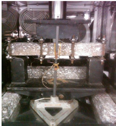
Figura 10: Ensayo de Flexión en 4 puntos con el extensómetro.
