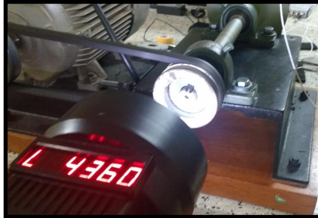
Figura 42. Medición de las RPM en la polea conducida.
