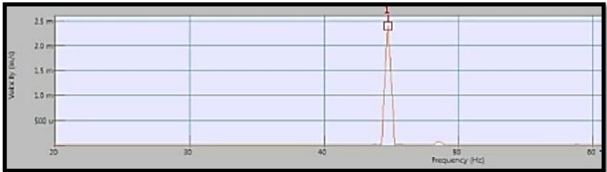
Figura 14. Espectro de frecuencia obtenida en los puntos de apoyo del caso 1, antes de la prueba.
