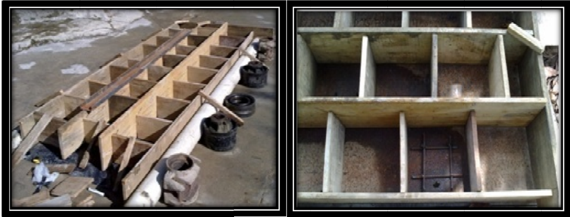
Figura 8. Formaleta diseñada para la elaboración de las probetas
