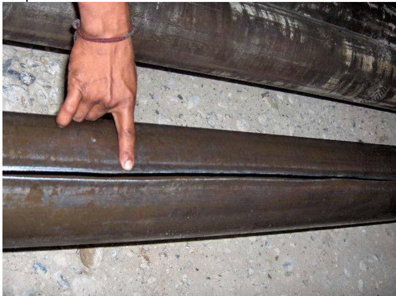
Figura 12. Falla por estallido
