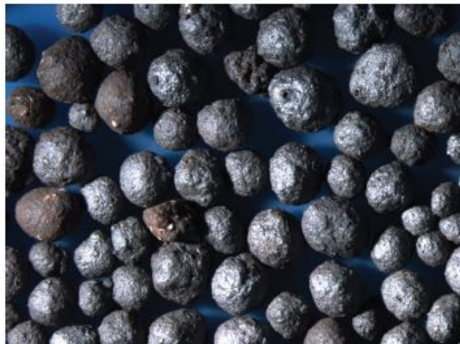
Figura 13. Distribución de partículas de un propante base Bauxita.
