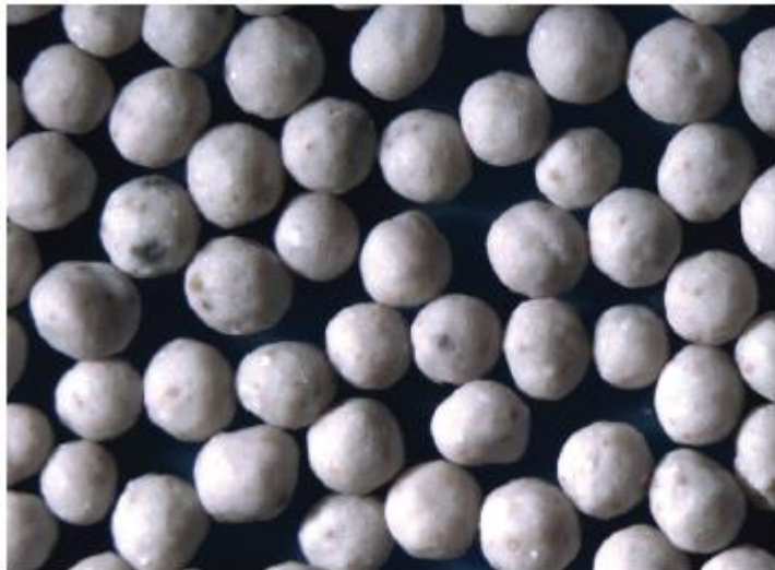
Figura 14. Distribución de partículas de un propante cerámico de bajo peso.
