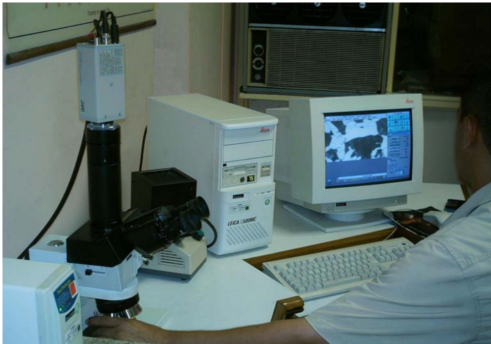
Figura 34. Sistema de adquisición y análisis de muestras metalográficas
