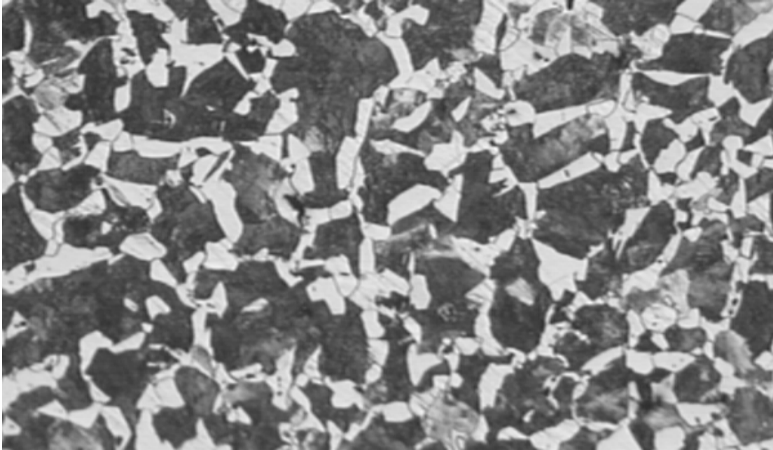
Figura 35. Microfotografía del acero ASTM 1045 a 100 x
