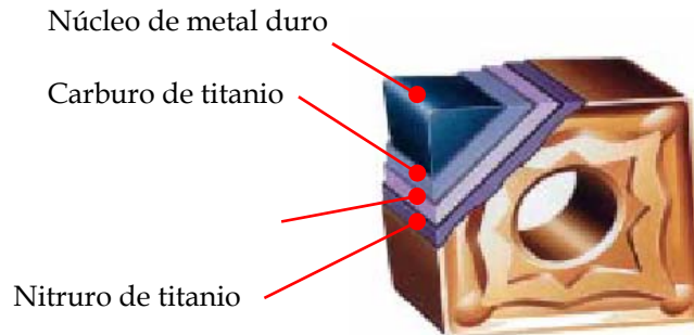
Figura 2. Representación esquemática de un inserto de metal duro con recubrimiento
