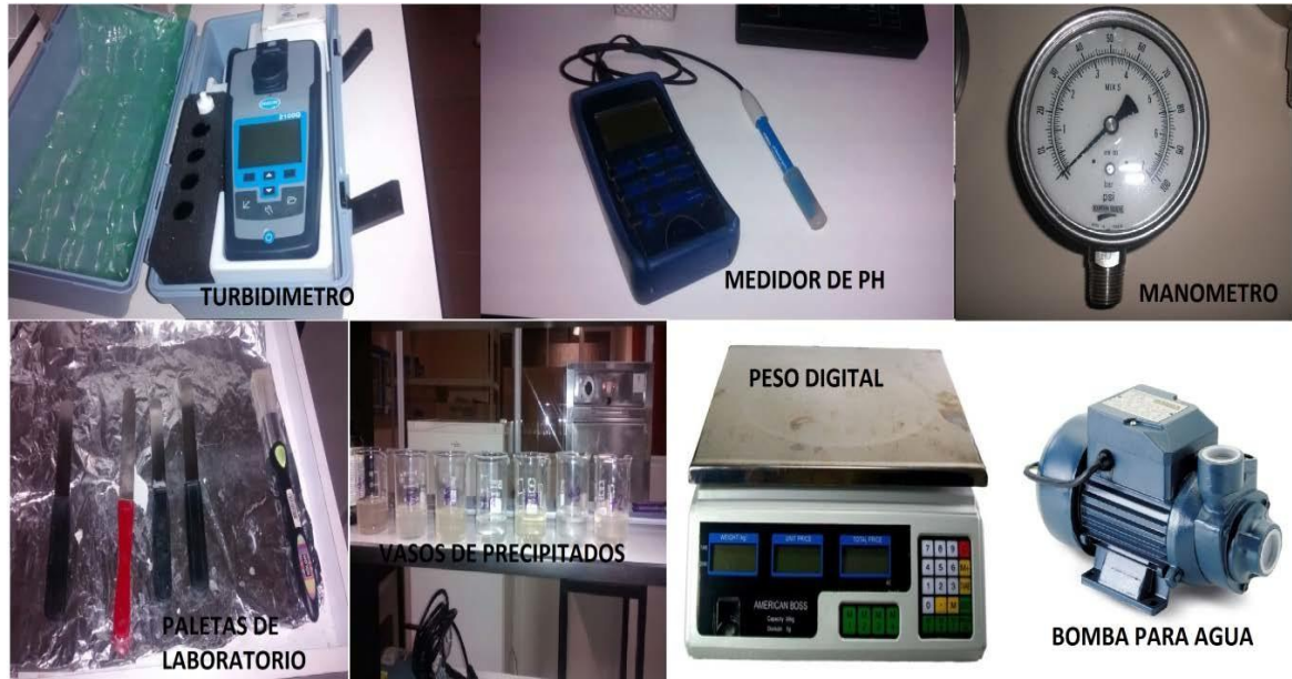
Figura 9 Equipos utilizados en las pruebas
