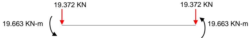
Figura 34. Fuerzas equivalentes para Viga biempotrada
