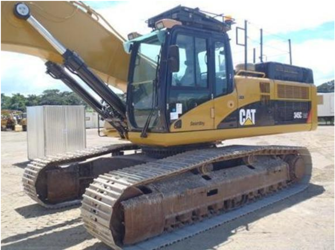
Figura 12. Fotografía de una excavadora 345C
