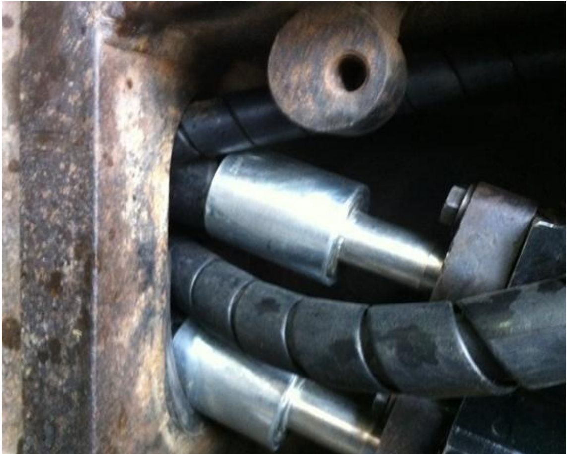
Figura 42. Fotos de líneas rozando con el borde del chasis.
