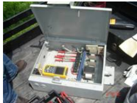
Figure 4-5: Caja de control utilizada para la alimentar el osciloscopio.
