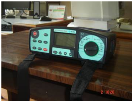
Figure 4–16: Aparato de medición de resistencia de puesta a tierra
